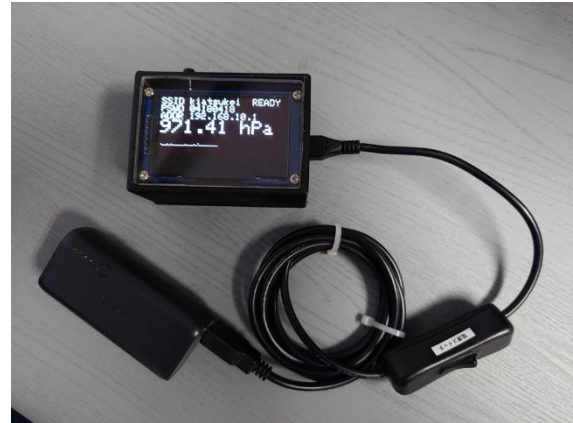
気圧変化確認装置
